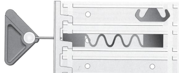
Les fermetures sont maintenues en position de verrouillage par défaut à l'aide du ressort. Normalement, ce verrouillage est suffisant. La plaque peut être retirée sans outil.
