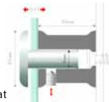
Distanzhalter für kleine Formate, Halter an der Wand befestigen, Schild montieren, Kopf durch das Schild in den Halter stecken und mit seitlicher Madenschraube im Halter sichern.
