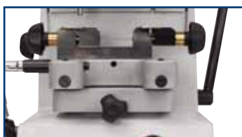
2 Verrouillage de l'axe de déplacement latéral.
