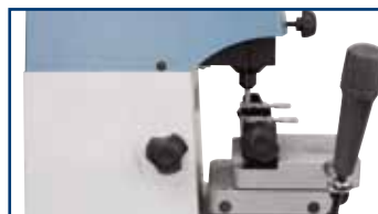
3 Blokada wałka przesuwania pionowego
