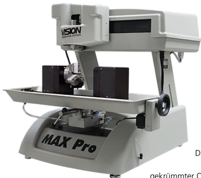
Die MAX PRO ist eine mehrachsige Rotationsgravurmaschine speziell geeignet für gefräste wie geritzte Rundgravuren. Mit Gravurgeschwindigkeiten von bis zu 254 mm pro Sekunde und einem abnehmbaren 203 x 305 mm T-Nuten Graviertisch kann die MAX PRO zylindrische Gegenstände bis zu 152 mm Durchmesser und flache Gegenstände bis zu 180 mm Dicke gravieren.
