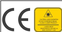
Lasersicherheitsklasse 1 für CO<sub>2</sub>-Lasergehäuse. Klasse 2 für roten Laserzeiger. Gehäuse der Lasersicherheitsklasse 1 ermöglicht den sicheren Betrieb, ohne dass der Laser in einem geschlossenen Raum oder mit Augenschutz betrieben werden muss.
